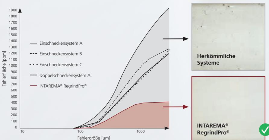
**Qualitätsprüfung der Regranulate:** Folientest mit Fehleranalyse auf einem OCS Messextruder ME25/25D-V3
